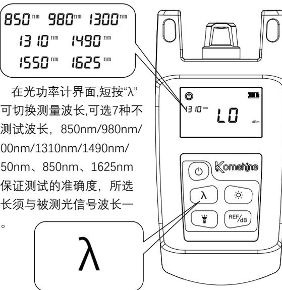
在光功率计界面,短按“λ”键可切换测量波长,可选7种不同测试波长, 850nm/980nm/1300nm/1310nm/1490nm/1550nm、850nm、1625nm 为保证测试的准确度，所选波长须与被测光信号波长一致。
