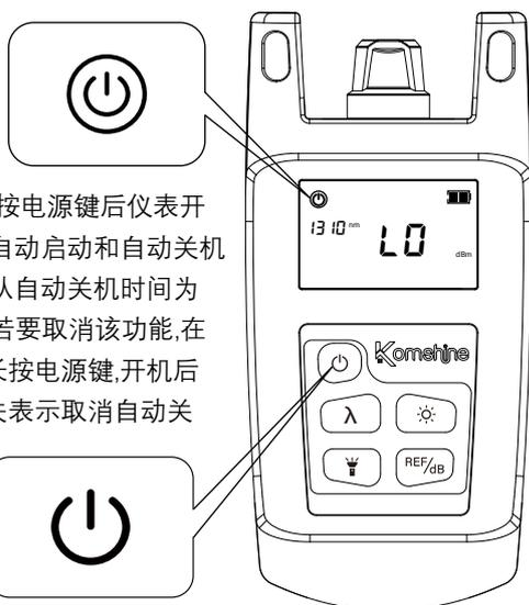
短按电源键后仪表开启,带有自动启动和自动关机功能,默认自动关机时间为10分钟,若要取消该功能,在开机时长按电源键,开机后图标消失表示取消自动关机。
