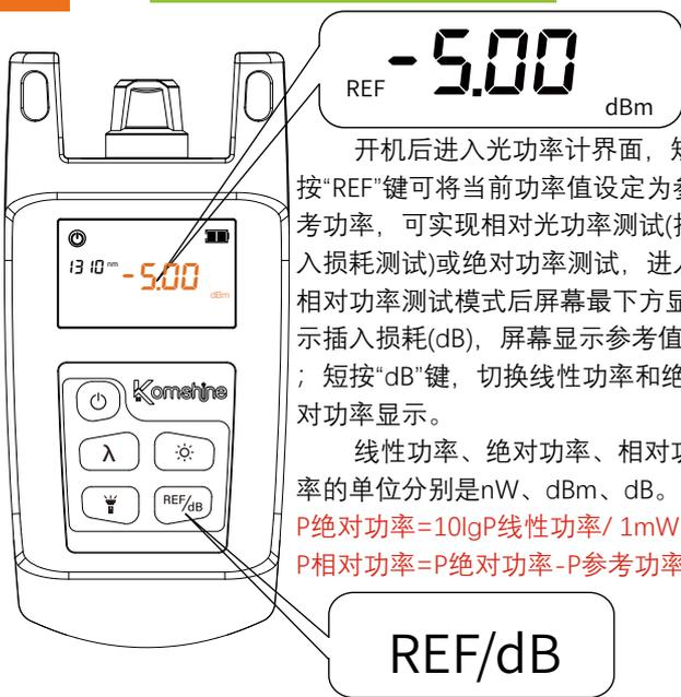
开机后进入光功率计界面，短按“REF”键可将当前功率值设定为参考功率，可实现相对光功率测试(插入损耗测试)或绝对功率测试，进入相对功率测试模式后屏幕最下方显示插入损耗(dB)，屏幕显示参考值；短按“dB”键，切换线性功率和绝对功率显示。
