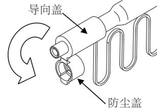
2. 将 SC 光纤接头插入导向盖
