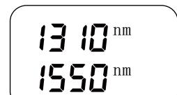
根据工程的需要，选择对应的波长来匹配光功率计。仪表开启后按“输出波长”键，输出波长依次切换到对应波长，并在显示屏上显示出。
