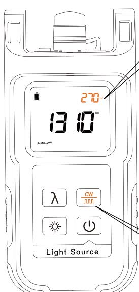
在实际工程中需要在光信号中加载音频载波用于识别光纤，仪表含有三种载波频率，分别为270Hz、1kHz、2kHz。
